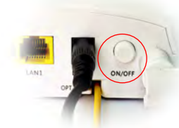
Bouton marche-arrêt situé à l'arrière de l'ONU (Optical Network Unit)
